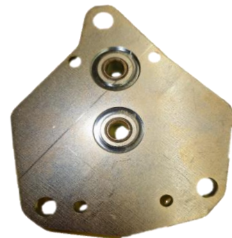
Adapter 400.479.000 Anschluss anstelle des Ölkühlers Connection instead of oil cooler
