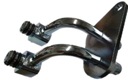
Adapter 400.469.000 Anschluss anstelle des Ölkühlers
