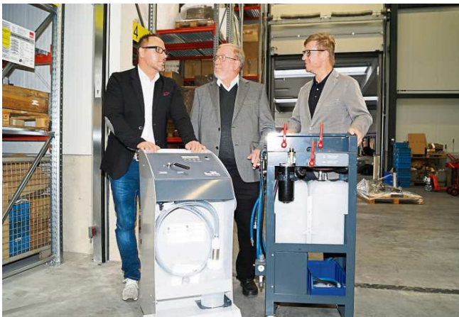
Holger, Adolf und Thomas Henzler (von links) mit zwei der Geräte für Autowerkstätten: Links ein Ad-Blue-Befüllgerät, rechts ein Spülgerät für Automatikgetriebe. Foto: rik
